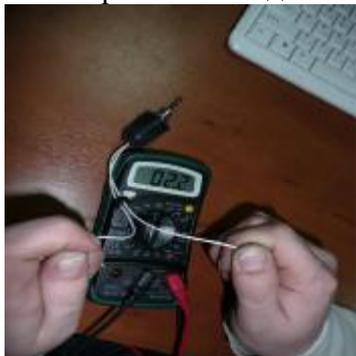
2. Снять верхнюю крышку отопителя, подсоединить щупы вольтметра к месту подсоединения проводов свечи к блоку управления. После включения отопителя напряжение на свече (при её исправности) должно медленно возрастать и на 30-40 секунде достичь 18В.
