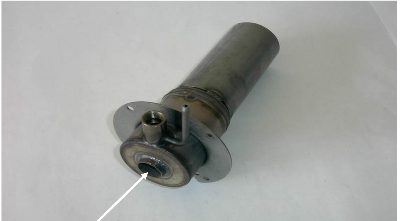
Рис 19-Камера сгорания без завихрителя
