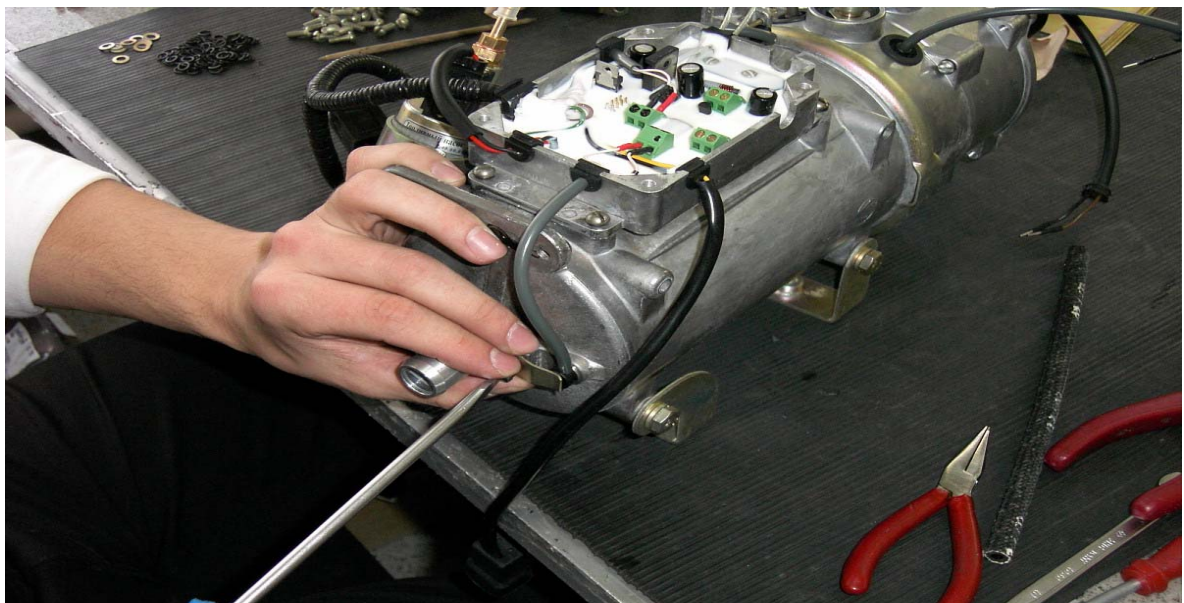
Рис.14- Установка и демонтаж датчика перегрева
