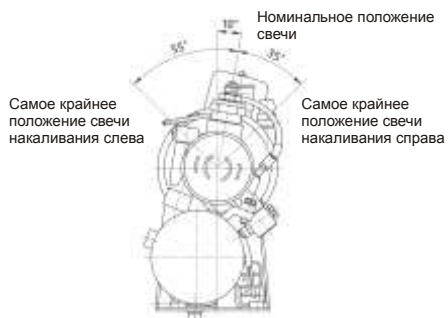
Рисунок 9 - Допустимое положение горелки по свече накаливания
