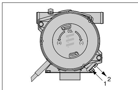
1 Подсоединение всасывающего трубопровода через кольцевой присоединительный патрубок Ø 6 мм
