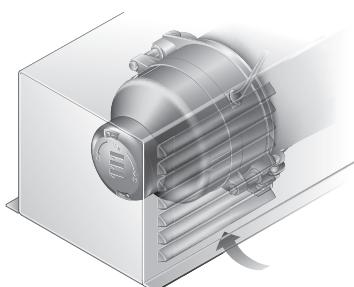
Засасывание воздуха для сгорания через гибкий шланг Ø 60 мм, длина макс. 1 м.
