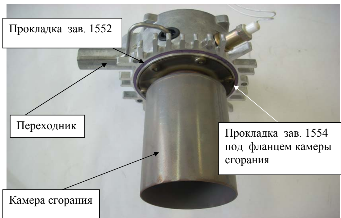
Рис. 5- Камера сгорания с переходником в сборе
