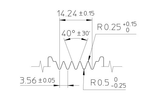
DETAIL OF ROTOR GROOVE (2:1)
