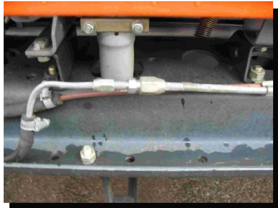
Подключение топливных магистралей трубками
